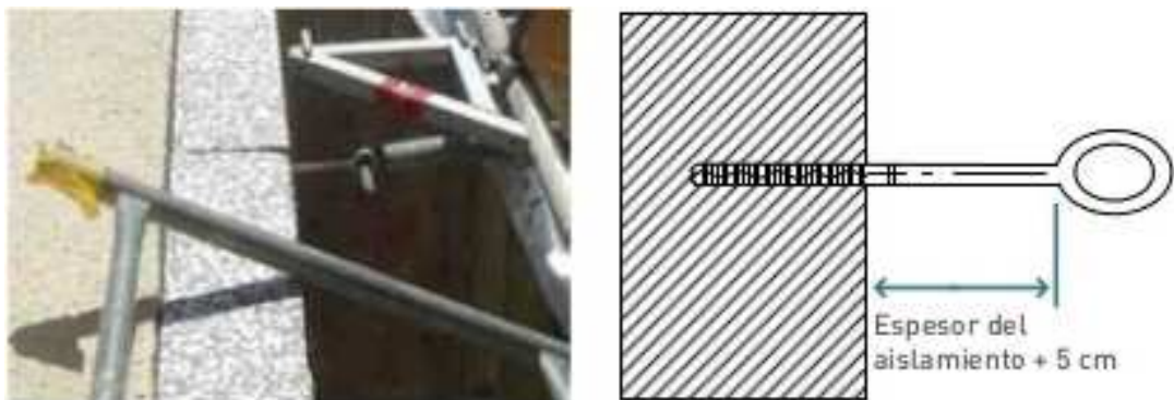
Figura 49. Detalle de la fijación del andamio a la fachada.
