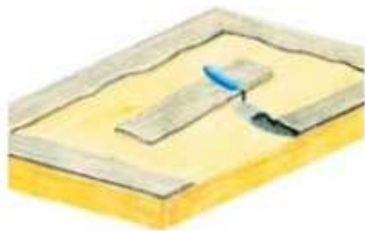
Pegado borde-punto en una plancha de MW. Además del adhesivo se debe reforzar con unas fijaciones mecánicas (por ejemplo, espigas)
