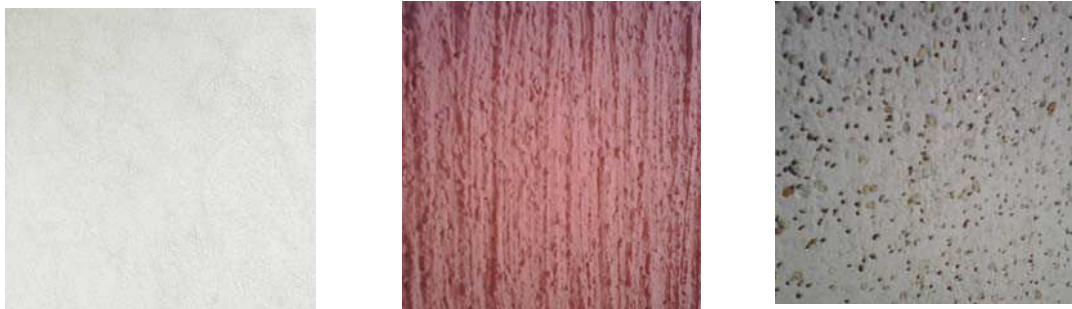
Figura 34. Texturas con efecto dado por rodillo de trapeado, con efecto por llana dentada triangular y liso con áridos proyectados.
